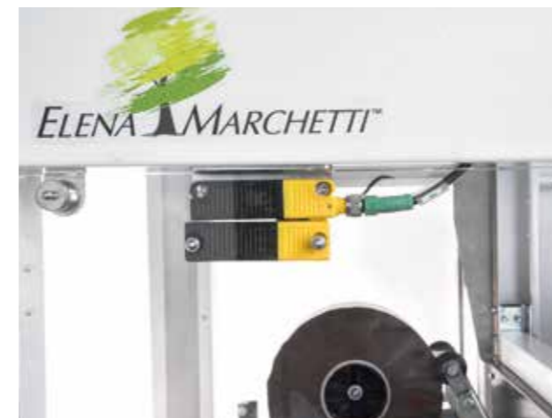
◀ Micro RFID a codifica unica. Unique coding RFID.
